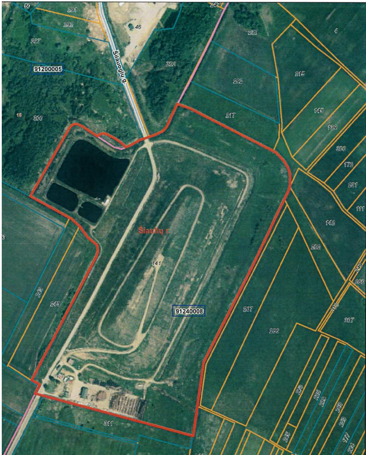
24. 1 pav. Šiaulių Visuomenės sveikatos centro 2015 - 09-14d. raštu Nr.S-4165 patvirtinta SAZ pažymėta raudona spalva. Ties filtrato tvenkiniu šiaurinėje sklypo dalyje SAZ išeina iš sklypo ribų. SAZ plotas yra 27,99 ha
